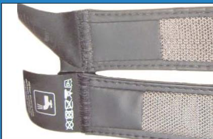
Электроды пульсовых датчиков на тканевой основе Polar WearLink. Визуально отличить полностью рабочий и неисправный — практически нереально. Металлическая проволока очень тонка, оценить её целостность на глаз невозможно. Только бирка может подсказать о частом использовании верхнего датчика.
