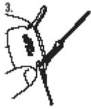
3 請將繩索穿過速度感測器與其橡膠墊上的小孔（如圖 3 所示）。調整感測器與自行車前叉的位置，使其 POLAR 標誌朝外（如圖 4 所示）。**同時將繩索調節得寬鬆一些，不要將它們系得太緊。**
