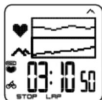
您可對圖表查看方式進行個性化設置、在上部與中部的行上，您可以選擇以圖表方式查看Power能量，Speed速度，Altitude海拔高度或者Heart rate心率數值。
